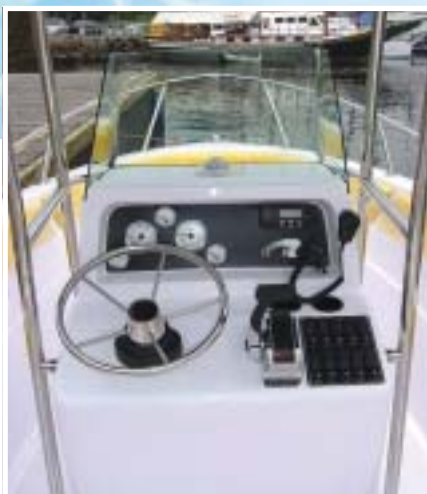
Pára-brisas moldados, portas de separação de ambientes, janelas, espelhos, box de banheiro e peças de mobiliário são exemplos do uso do acrílico na indústria náutica
