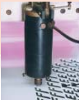
O corte a laser dispensa o polimento
